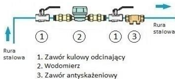
Schemat montażu wodomierza dla ciśnienia do 0,6 MPa
